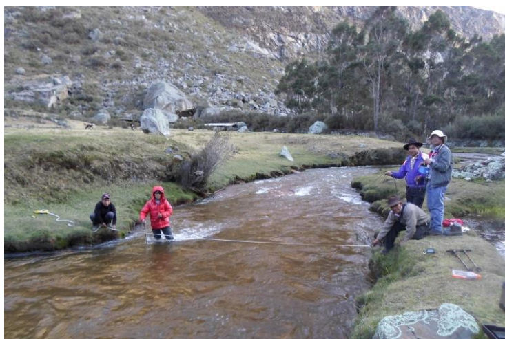
Fotografía N° 27: Medición de caudales usando correntómetro en la quebrada Quilcayhuanca.
